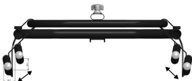
Le réglage de largeur des tubes du dossier est de 25 mm. Les parties supérieures et inférieures des tubes peuvent être réglées individuellement pour répondre à des besoins différents. Le mouvement vers l'extérieur encadrera l'utilisateur et offrira un support latéral.
